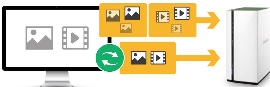
Les vidéos peuvent être transcodées/converties avant d'être transférées vers le TS-x28A, ce qui aide à réduire la charge sur le processeur du NAS.
