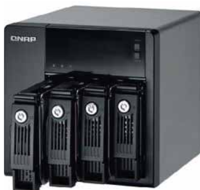
Platz für vier SATA-Platten über Hot-swappable Disk-Trays.
