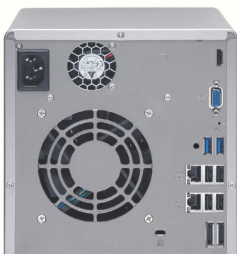
↑ QNAP TS-469 Pro Turbo NAS機身後方，設有HDMI及D-SUB端子，用戶可藉此進行影音直輸出播放。
