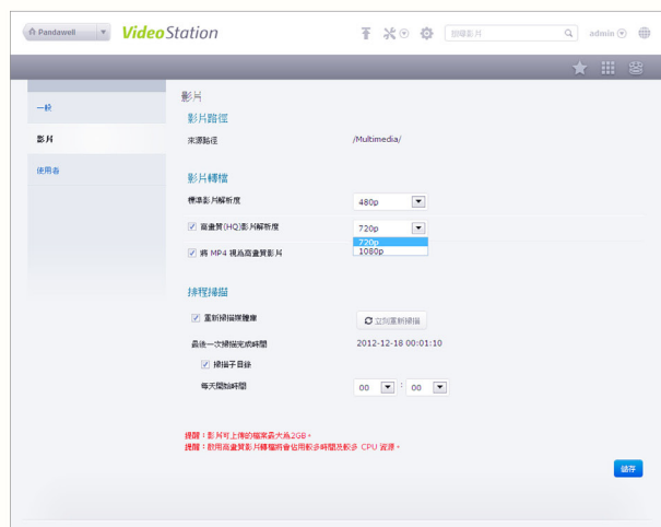
↑若想透過DLNA傳輸播放，卻又碰到影音不同步及破圖問題，可先將影片轉成720P或480P，在流量較低的情況下，觀賞起來較為流暢不卡卡。
