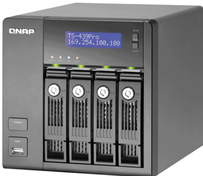
servidor de impresora, servidor Web y replicación remota cifrada; soporta Windows AD (Active Directory) para facilitar la creación de un entorno de fácil acceso y reducir el coste de mantenimiento; y permite al usuario transferir, almacenar y compartir datos de forma segura gracias a su inicio de sesión SSH y SSL de página Web.
