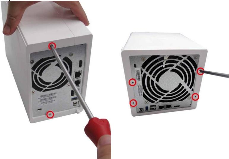
5. Com cuidado, retire a tampa do gabinete do NAS, deslizando-o mais (veja a parte inferior do NAS para indicadores visuais do NAS caso seja bloqueado/desbloqueado)
