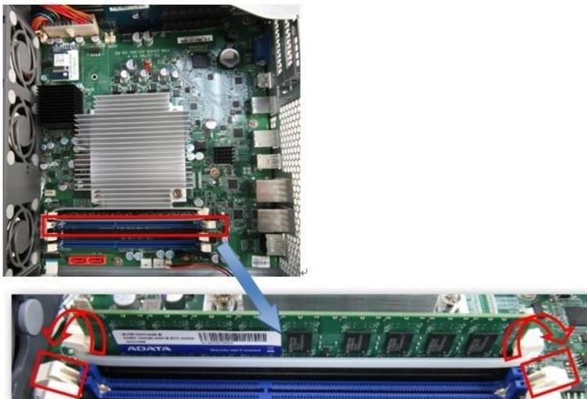
4. Segure a extremidade do módulo de RAM. Alinhe a ranhura na borda dourada do módulo de RAM com a ranhura da fenda de RAM. Insira o módulo de RAM na fenda de RAM até que ele não vá mais para frente.
