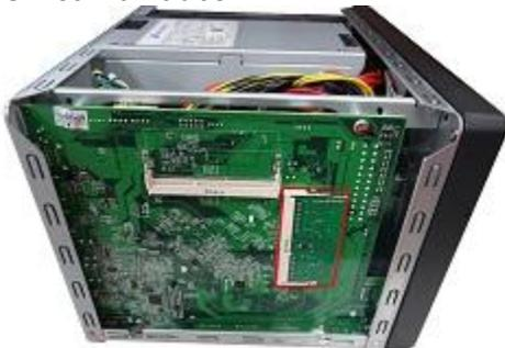
6. Segure a extremidade do módulo de memória. Alinhe a ranhura na borda dourada da placa com a ranhura da fenda de memória. Deslize o módulo de memória para a fenda em um ângulo de 45 graus (aproximadamente).
