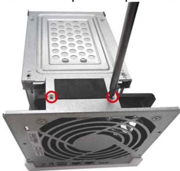
8. Remova cuidadosamente o compartimento do disco rígido do NAS, elevando-o para fora do slot.
