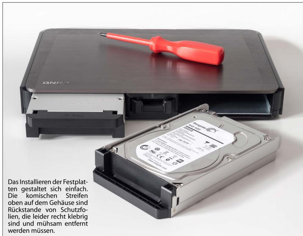
Das Installieren der Festplatten gestaltet sich einfach. Die komischen Streifen oben auf dem Gehäuse sind Rückstände von Schutzfolien, die leider recht klebrig sind und mühsam entfernt werden müssen.
