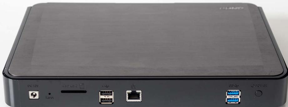
Rückansicht: Neben USB-Ports z.B. für WLAN-Adapter, Drucker oder Backup-Festplatten ist auch ein SD-Card-Slot vorhanden.
