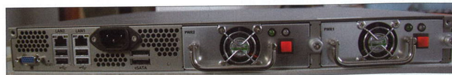
图2 该机采用双电源备份设计,还具有防雷保护设置。
