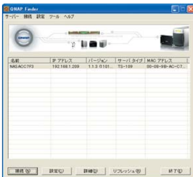
写真3 ■ Windows用の初期設定ツールが付属しており、LAN内のTS-109 Proを自動検索して設定することが可能だ
