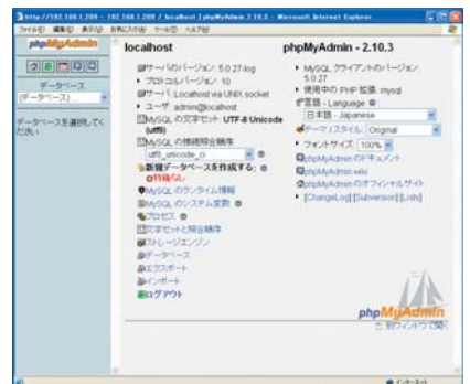
写真4 ■ TS-109 ProはPHPをサポートしたWebサーバ機能を搭載している。PHPの管理もWebブラウザから行える
