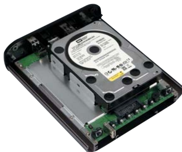
写真2 ■ アルミ製のケースを開けて、3.5インチのハードディスクを搭載する。SerialATAのインターフェイス部分を差し込んでネジ止めするだけなので、取り付け作業は簡単だ
